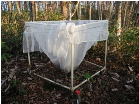
図-6 森林の葉量を計測するためのリタートラップ
